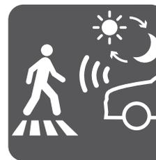
**PRE-COLLISION SYSTEM (PCS) avec détection des piétons** Dès que le système détecte un risque de collision, le conducteur est prévenu par des signaux acoustiques et optiques, et l'assistance au freinage est activée. Lorsque le conducteur ne réagit pas à temps, le véhicule freine automatiquement afin d'éviter une collision ou d'en atténuer les effets.
