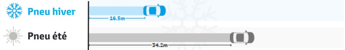
**Freinage sur sol sec** - Distance de freinage à partir d'une vitesse de 100 km/h, Temp. > 15°C
